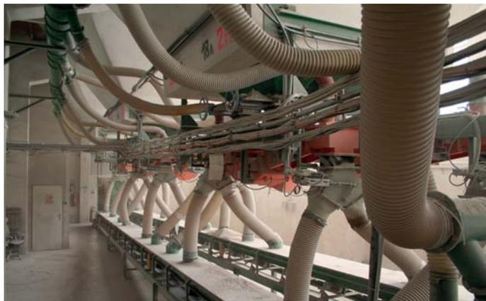
**Wichtige Bestandteile des Verarbeitungsprozesses des gebrannten Materials sind die nachfolgende Sortierung und das Mahlen.** Außer der üblichen groben und feinen Standardmahlung bietet die Firma České lupkové závody, a.s. auch eine genaue Absiebung mit garantiertem Ober- und Unterkorngehalt sowie mit garantierter Kornverteilung an.
